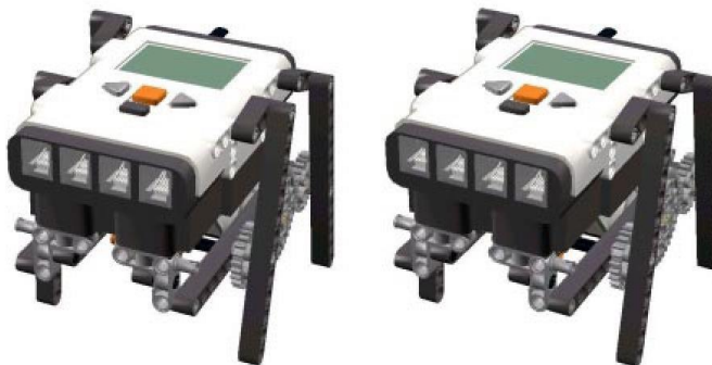
Рис. 2. Четвероногий робот устойчив, как табурет (стереокартинка)
