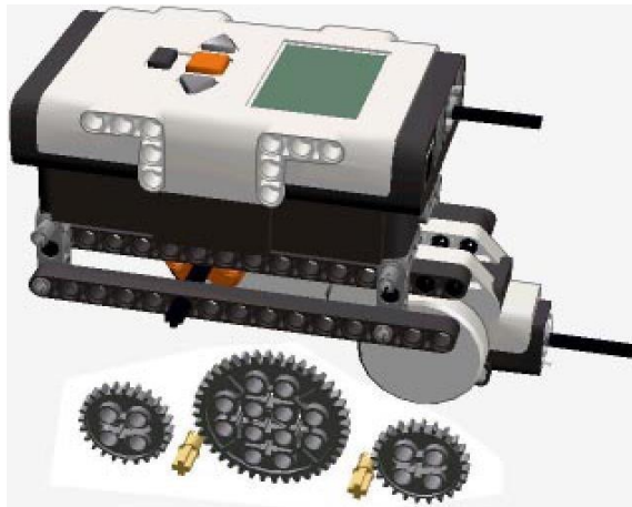
Рис. 7. На ведущие оси насаживаются 24-зубые шестерни
