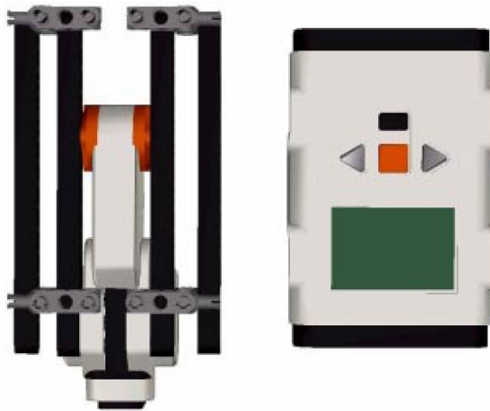
Рис. 5. Контроллер крепится к угловым балкам
